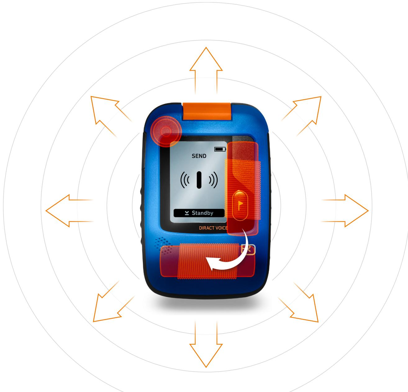
ダイレクト、及びダイレクトボイスには、特許取得済みのスマートアンテナテクノロジーが搭載されています。この技術は、雪崩の中でデバイスの位置状態を分析し、2重のサポートを提供します。一つは、雪崩が収まった後に送信性能を向上させること。もう一つは、最適な送信アンテナに自動的に切り替えることです。最大で2倍の範囲をカバーし、より発見されやすくなります。
