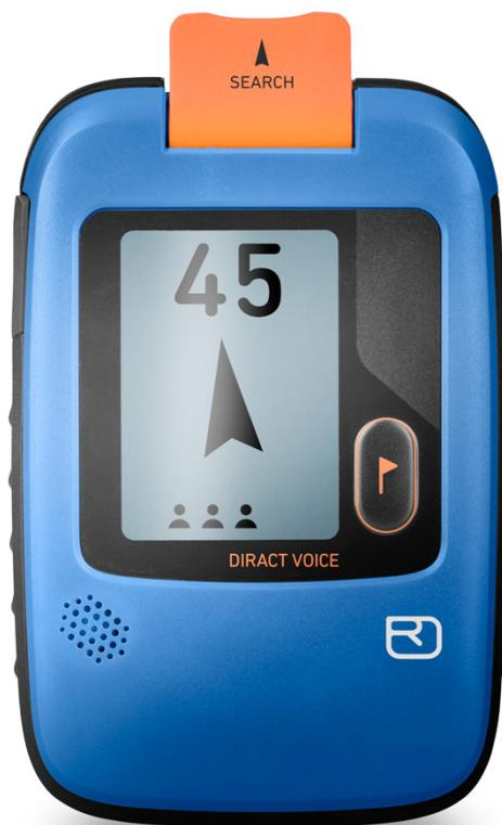
ダイレクトボイスは、ORTOVOXが開発した音声ナビゲーション機能付きの雪崩トランシーバーです。明確でシンプルな音声ナビは、全ての搜索段階で貴方をサポートします。冷静で明確な指示を提供することで、あなたのパートナーの生存を最優先で手助けします。
