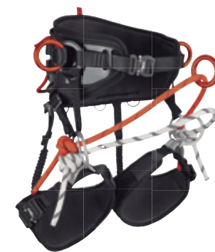
側面 ウェストとレグループのクイックバックルはグローブをはめていても装着と調整が容易 側面から背面にかけて4つのギア取付用スチールリングを装備
