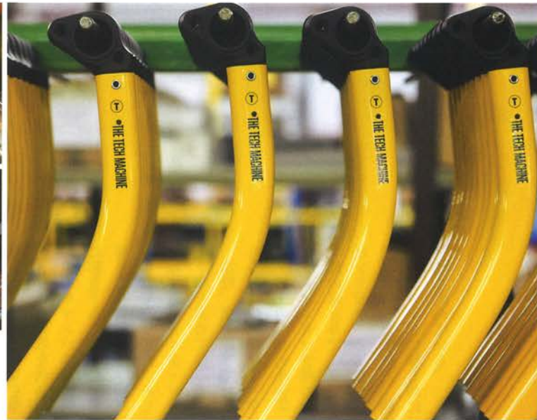
上) ブレードの取り付けを待つアイスアックスのシャフト。左上) 自動的に樹脂部品を装着。左下) ブレードなどは国内にある別の自社工場で作られ、ここに集められる
