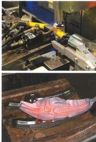
製造されたカラビナは、最後に製品の一点一点が破断強度の半分のみで検査が行なわれる。そして、同じ機械の中でシリアルナンバーが刻印されたのち、出荷されていく
