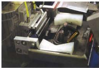
製造されたカラビナは、最後に製品の一点一点が破断強度の半分のみで検査が行なわれる。そして、同じ機械の中でシリアルナンバーが刻印されたのち、出荷されていく
