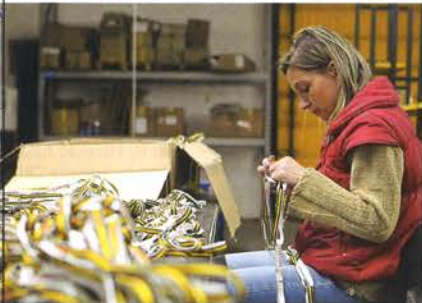
完成したデジチェーンを検査中。登山者の命を守る製品だけに、同社ではいたるところでこうした検品作業が行なわれている
