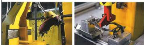
左) 重りを入れた振り子状の機械にクランポンを装着して、前爪の耐久強度を確認するテスト。右) こちらは、無理な力を一箇所に加えたときのテスト
