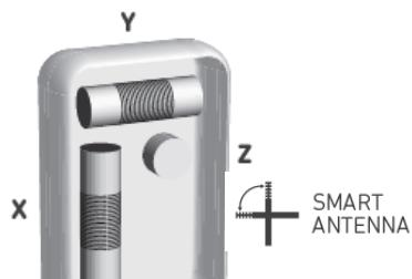
検索中は3アンテナ全てが使用されます。XとYアンテナが距離と方向の指示に使用され、Zアンテナは単にファインサーチに使用されます。
